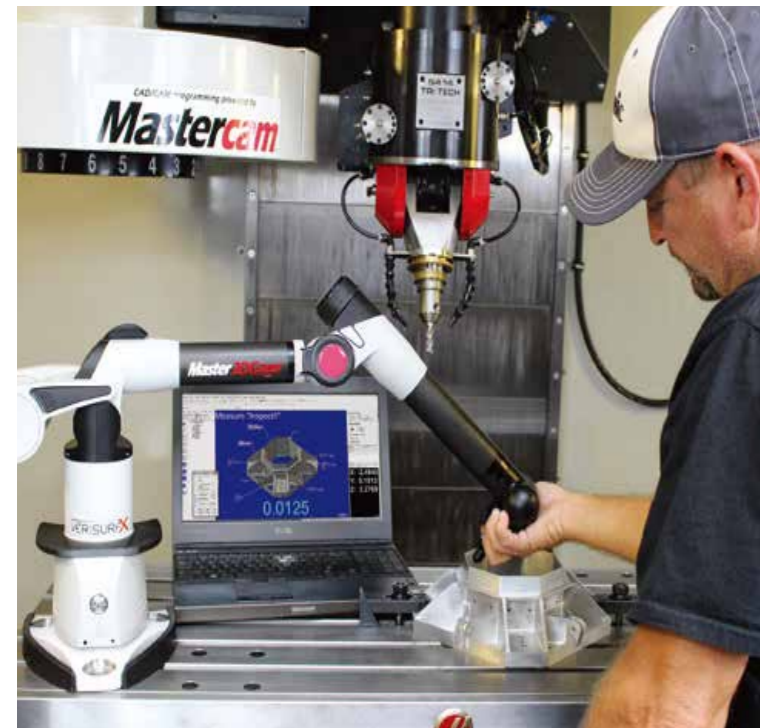
工作機械に乗せて工程内検査をする事で、能率よく、高精度な検査、加工が行えます。
