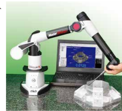
業界をリードする検査ソフトウェアVerisurfを搭載したMaster3DGage™は、機械工場に合わせたアプリケーションと予算に合った機能を設定することができます。
