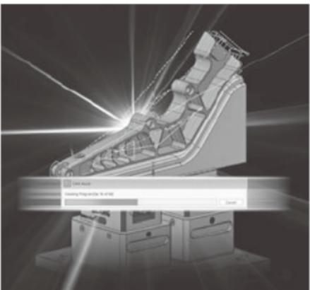
加工工程や加工条件を約80%自動作成④Mastercamに搭載されたポストプロセスでNCプログラム出力と簡単。自動作成した工程や条件も必要に応じ
